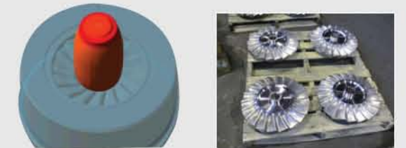
航空航天Ti合金零件-锻压成型模拟 使用对称方式进行建模-计算
