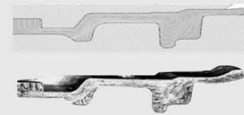
航空航天铝合金零件-锻压成型模拟 铸造组织流动控制
